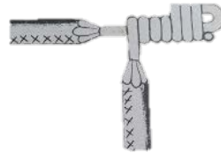
Ilustración 10. Empalme toma doblada
